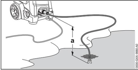
Para permitir que a água seja aspirada, a diferença de altura entre a lavadora e a fonte de água não deve exceder a altura máxima de aspiração (a), 18.
