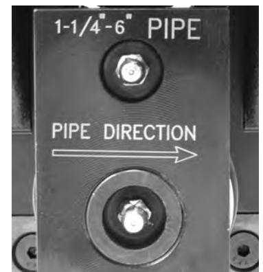
Figura 4. Dirección de tubería en el bloque de deslizamiento
